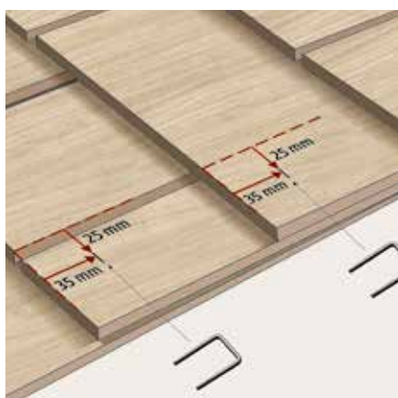
Figur 7 Korrekt placering af skjult montage med klammer
