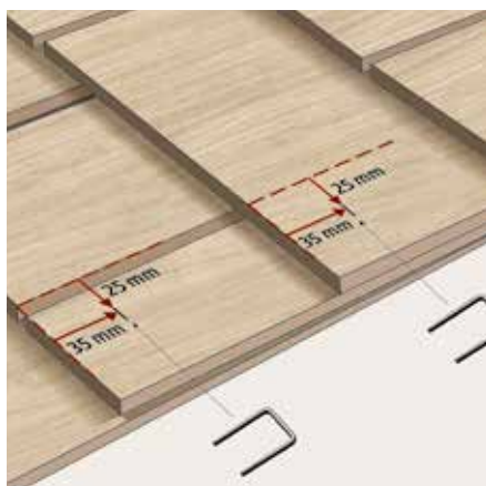
Figur 7 Korrekt placering af skjult montage med klammer
