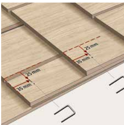
Abbildung 1 Korrekte Platzierung der verdeckten Befestigung mit Klammern
