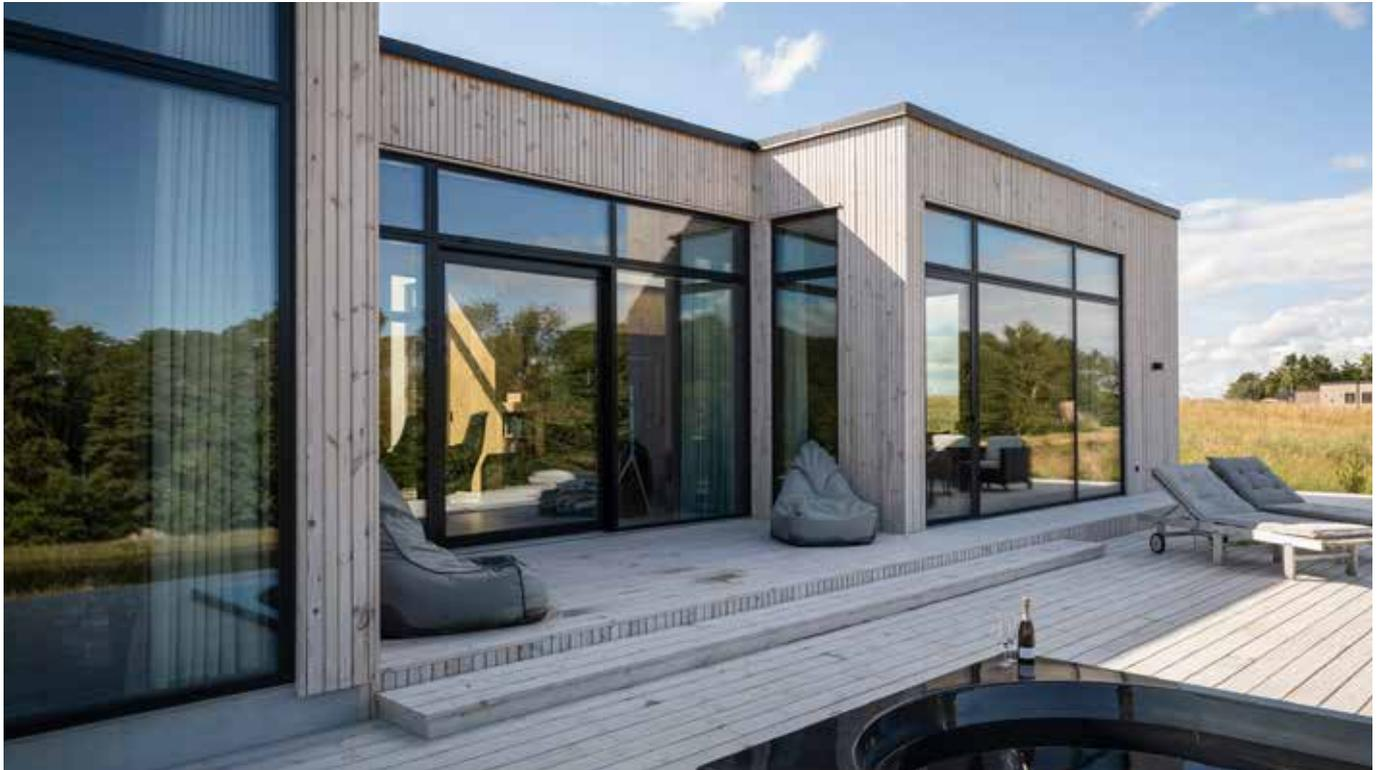
Sature® ist eine silikatimprägnierte Qualitätskiefer aus zertifizierten nordischen Wäldern und ein neues, bahnbrechendes Produkt für die Bauindustrie. Die Silikatimprägnierung besteht aus Sand (Silikat) und Wasser und ist eine Imprägnierung, die das Holz vor Fäule und Pilzen schützt und es dadurch langlebiger macht. Sature® ist robust und besonders für Terrassen und Fassadenverkleidungen geeignet. Es ist eine gute Alternative zu druckimprägniertem Holz.
