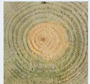
Nach NTR-Norm bis zum Kern imprägniert
