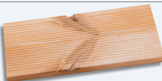
Brædder med funktionsnedsættelse og risiko for brud
