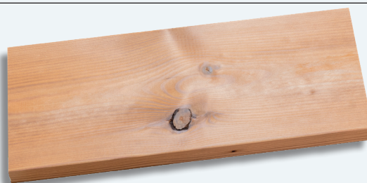
Barkringsknaster der sidder fast
