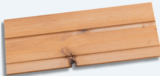
Defekter, som ikke er synlige efter montering
