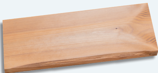
Små kantskader op til 30 cm
