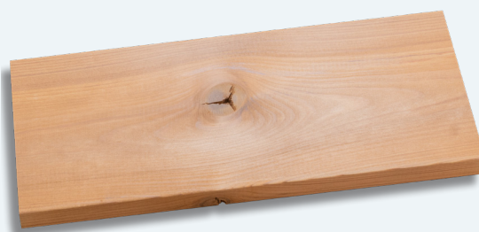
Knaster med stjerner opstået ved termobehandling
