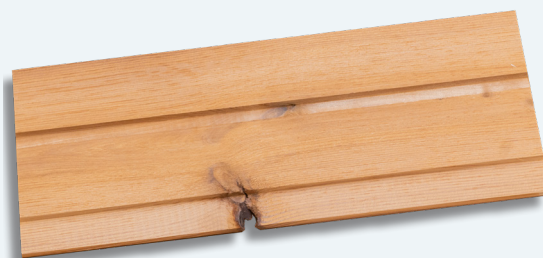
Defekter, som ikke er synlige efter montering
