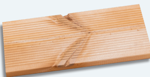
Terrassebrædder med funktionsnedsættelse og risiko for brud
