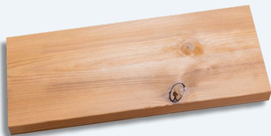
Sortknast der sidder fast
